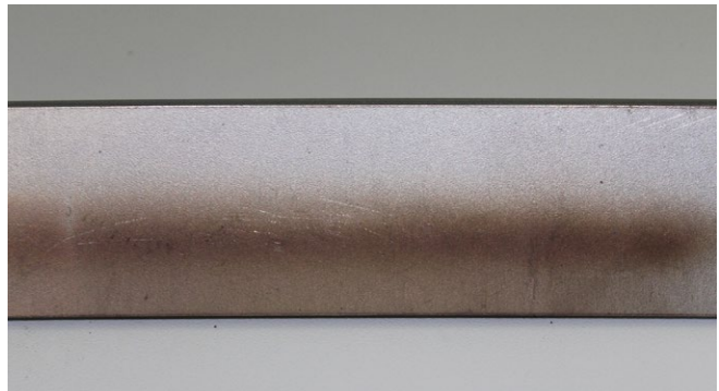
Rückseite: Geringe Wärmeeinbringung bei forceArc puls ® XQ, weniger Oxidation der Oberfläche
