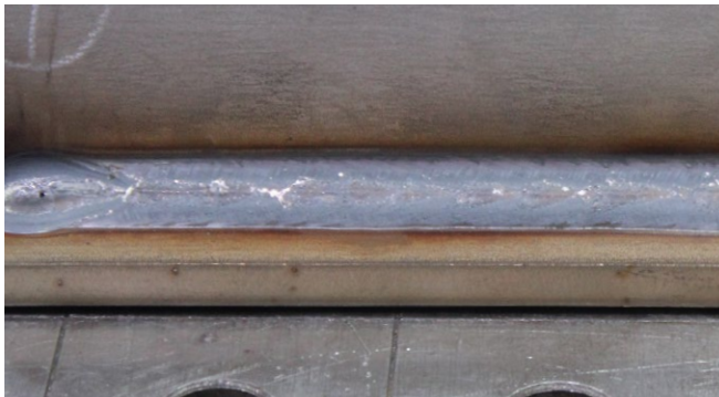
Vorderseite: Kleinere Wärmeeinbringung bei forceArc puls ® XQ, weniger Oxidation der Oberfläche, dadurch bessere Optik
